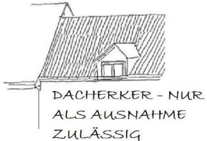
Analog zu den Hauptdächern sind auch bei den Gauben knappe Dachüberstände sowie einfache Trauf- und Ortgangausbildung auszuführen. Die Gestaltung der Ansichtflächen bzw. der Gaubenwangen erfolgt mit Putz oder als gestrichene Holzfläche vorgeschrieben. Dies entspricht dem, was im betrachteten Bereich traditionell üblich ist und im Sinne einer möglichst leichten und klaren Wirkung der Dachaufbauten im Dach erscheint.
