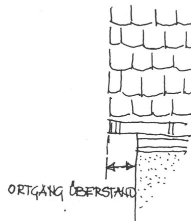
Die im Gebiet üblichen Biberschwänze aber auch flachen Dachpfannen mit unterschiedlichen Ausführungen führen in Verbindung mit der typischen Ortgangausbildung zu einer optisch geringen Materialstärke der Dachhaut, so dass die Gebäude, trotz der hohen und schweren Dächer, nicht erdrückt werden. Die Verwendung von Ortgangformziegeln verfremdet das überlieferte Erscheinungsbild stark und sollen daher ausgeschlossen werden.
